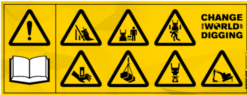
Afbeelding41. Waarschuingssticker aan rechterzijde van de machinist.
